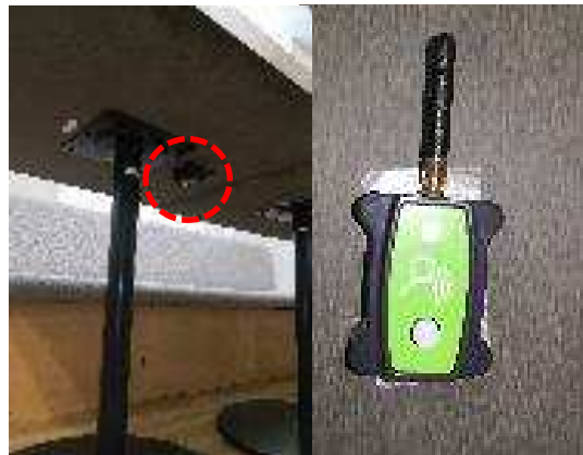
人感センサー (共用スペーステーブルの裏面に設置)
