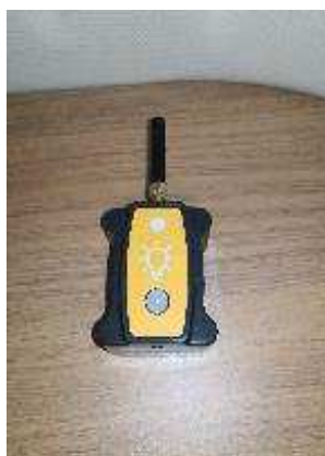
照度センサー (ミーティングテーブルに設置)
