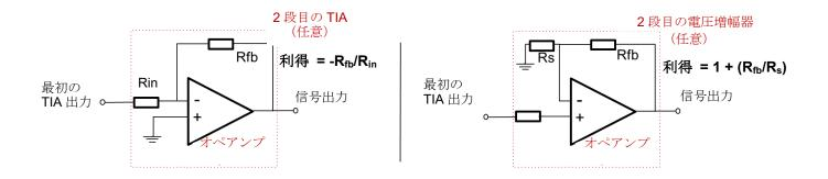
図 1:例:Broadcom AFBR-S4E001 の簡易読み出し方式
